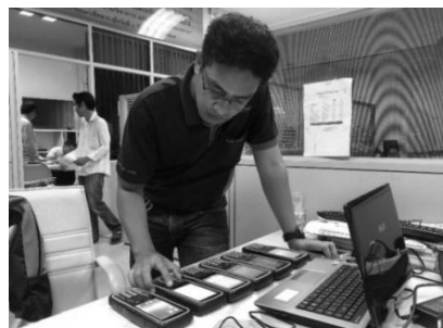
การตรวจสอบเครื่องรับสัญญาณดาวเทียมแบบเคลื่อนที่ (ROVER)
