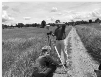
การตรวจสอบเครื่องรับสัญญาณดาวเทียมแบบเคลื่อนที่ (ROVER)
